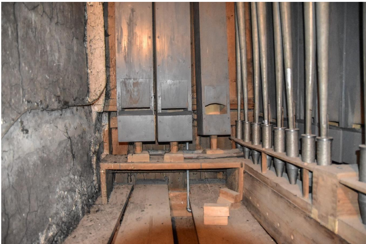
Fotografia 130 – odstawki największych piszczałek 16-stopowego rejestru krytego i smyczkowego w sekcji pedałowej, forszałgi kontrabasowe wyposażone w bródki, w Subbasie wycięcia półokrągłe; po prawej stronie piszczałki Bombardonu 16' z zakrzywieniem rezonatorów powstałym wskutek braku odpowiedniej stabilizacji
