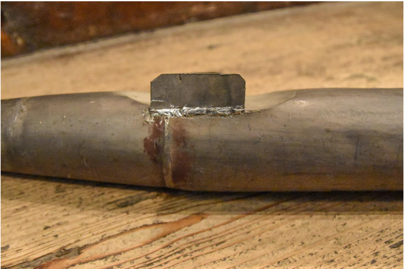
Fotografia 111 – ślad ingerencji w postaci mało estetycznie wykonanego lutowania baczków do obszaru labium
