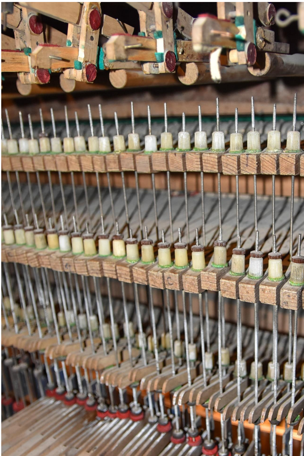
Fotografia 37 – pochodzące najprawdopodobniej z czasu remontu w 1967 r. nakrętki regulacyjne na styku ramion klawiszy i początku traktury gry
