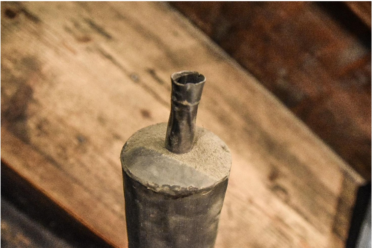
Fotografia 120 – wykrzywiona rurka puszczalki półkrytej z zalutowanym na stałe deklek
