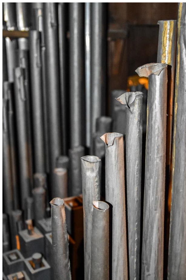
Fotografia 16 – zniszczone korpusy piszczałek ciętych na ton przez rozerwanie ich górnych części podczas strojenia bez użycia stosownych narzędzi
