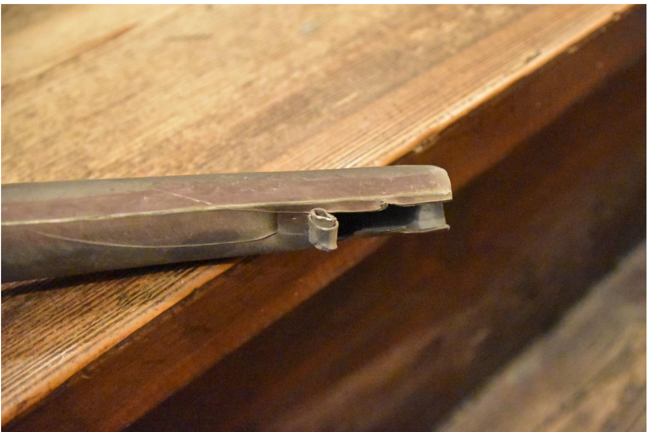
Fotografia 121 – ślady krzywego nacięcia linii wyznaczających szerokość dostroika w formie ślimacznicy
