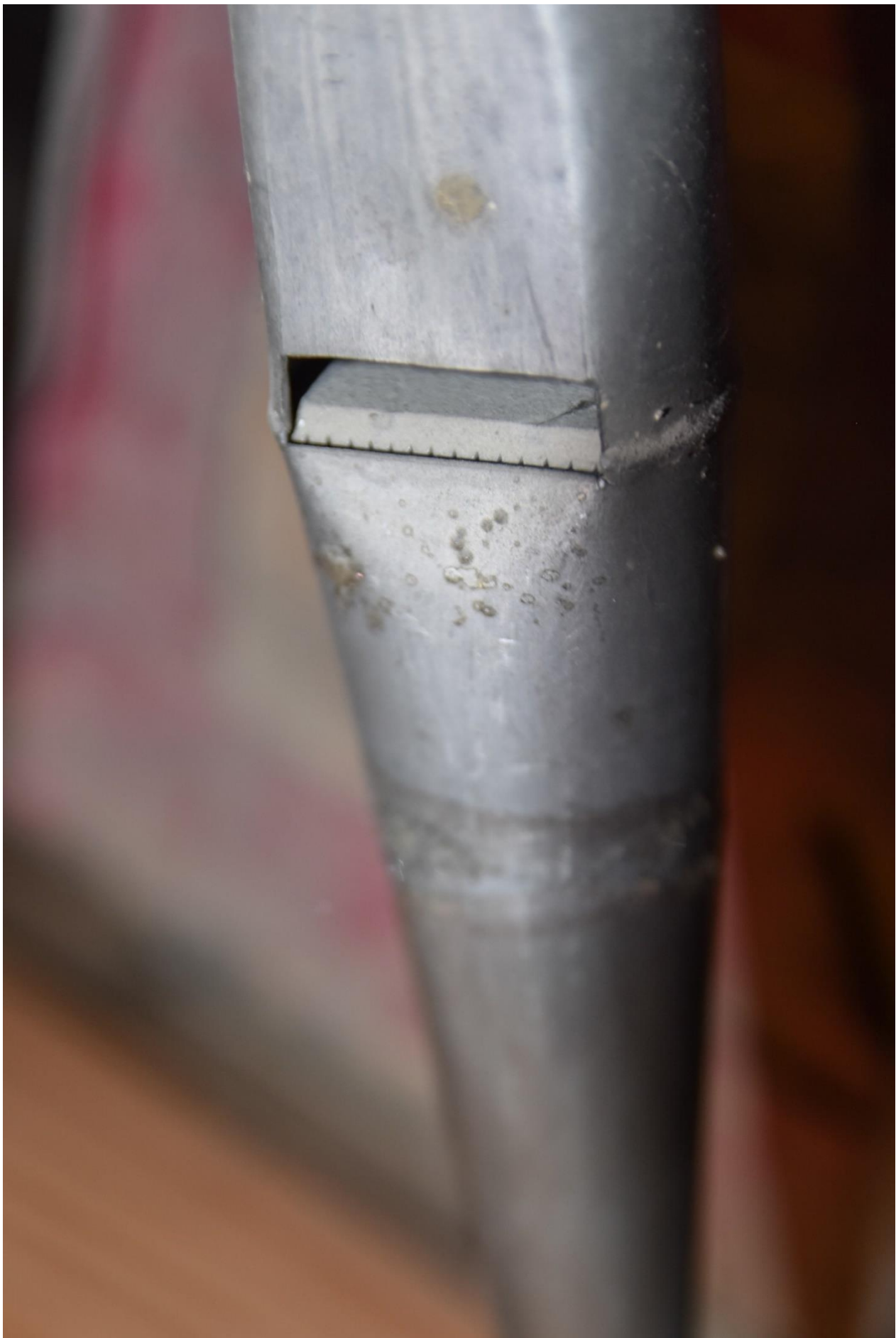
Fotografia 100 – nowsze piszczałki, charakterystyczny płaski kąt ustawienia rdzenia, gęste ząbkowanie
