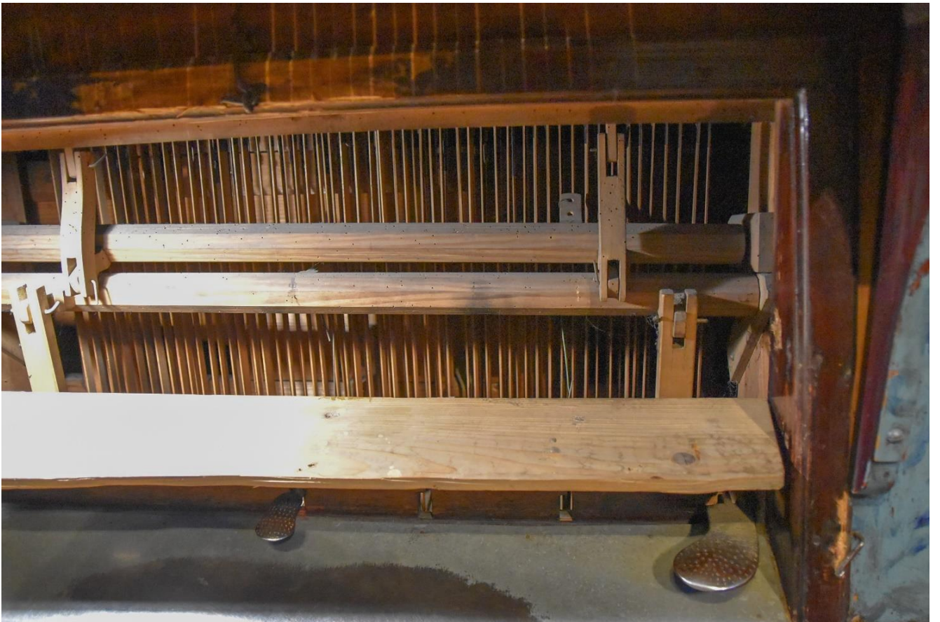
Fotografia 19 – włóczniki nożne, wałki skrzytne mechanizmu przekazującego impuls
