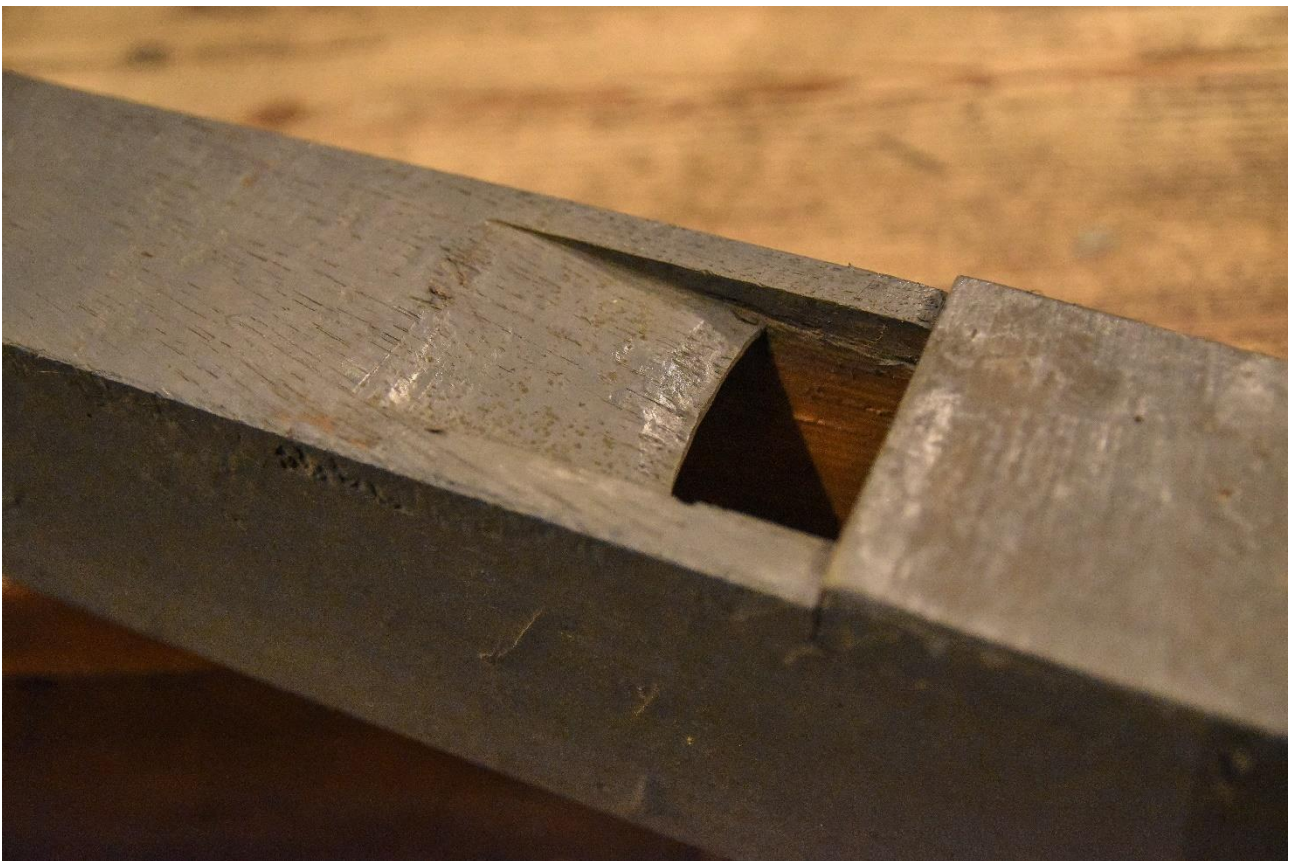
Fotografia 123 – lekko zaokrąglone wycięcie labium w puszczalce drewnianej
