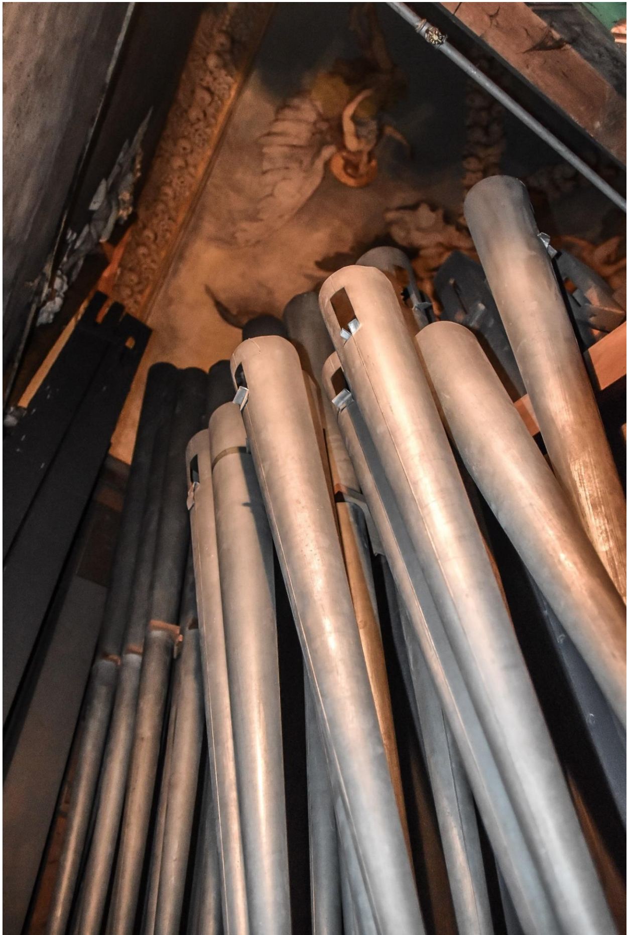
Fotografia 133 – znacznie odchylone od pionu rezonatory językowego głosu sekcji pedałowej, niepokój budzi sposób ustawienia regulacji długości rezonatorów, w niektórych piszczałkach rozerwano blaszki regulujące
