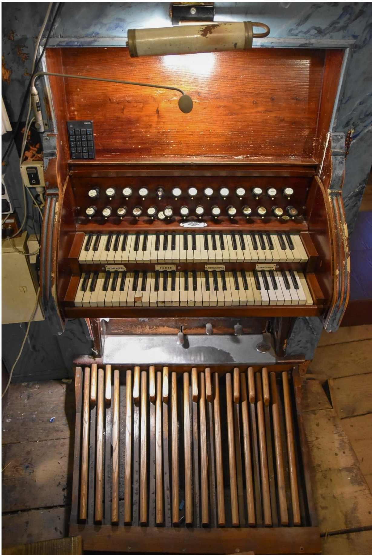
Fotografia 12 – stół gry, widoczne dwa rzędy cięgien rejestrowych, między-manuałowe tabliczki opisujące działanie dźwigni nożnych, w tym trzystopniowej regulacji otwarcia szafy ekspresyjnej; ogólny stan nadający się do restauracji
