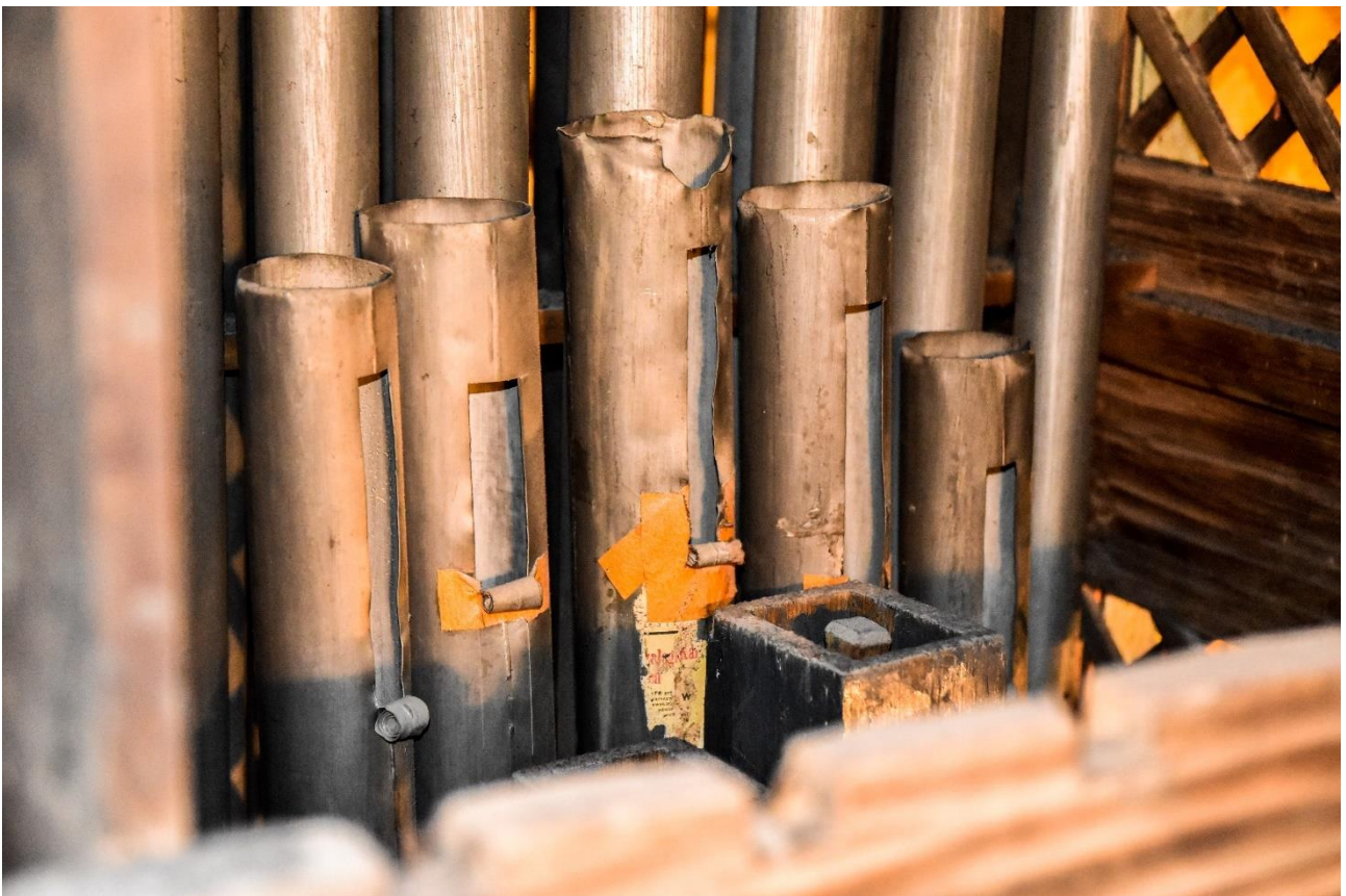
Fotografia 85 – cylindryczne otwarte piszczałki metalowe wyposażone w okna ekspresyjne
