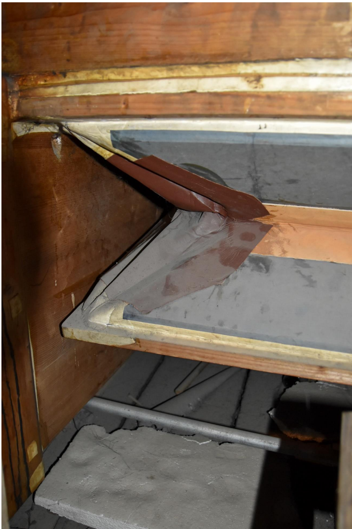
Fotografia 4 – ślady prób uszczelnienia miecha w postaci trzy warstw: oprócz tradycyjnego skórowania garbowaną bezchromowo skórą w kolorze białym użyto łąt na fałdzie oraz rogu miecha; zauważalny nieestetyczny sposób wklejenia oraz użycie materiału skóropodobnego
