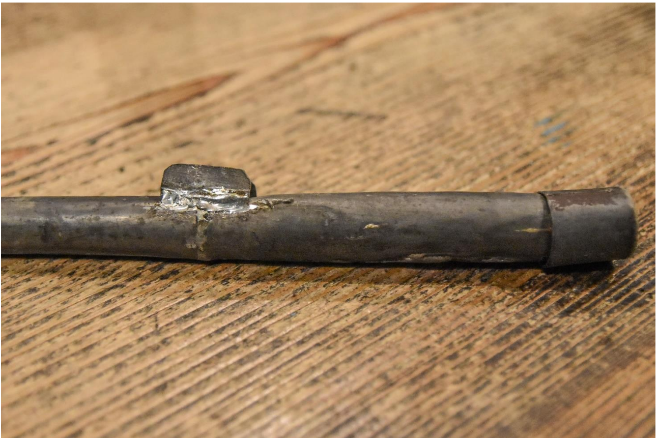
Fotografia 125 – metalowa piszczałka kryta ze śladami wtórnego dolutowania najprawdopodobniej oryginalnie występujących baczków
