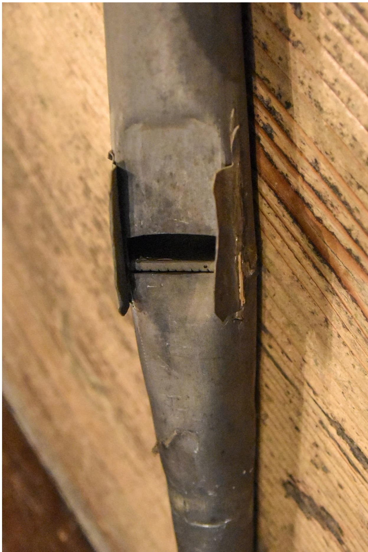
Fotografia 108 – powykrzywiane baczki, wycięcie górnego labium z lekkim łukiem, wysokie ustawienie kerna, ślad nowszego lutu na styku baczków
