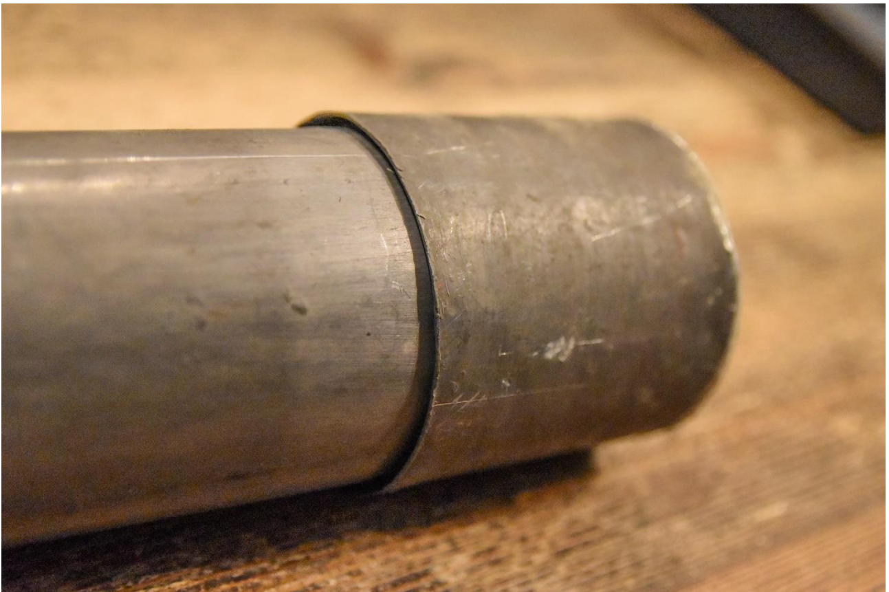
Fotografia 115 – ruchomy dekiel metalowej piszczałki krytej
