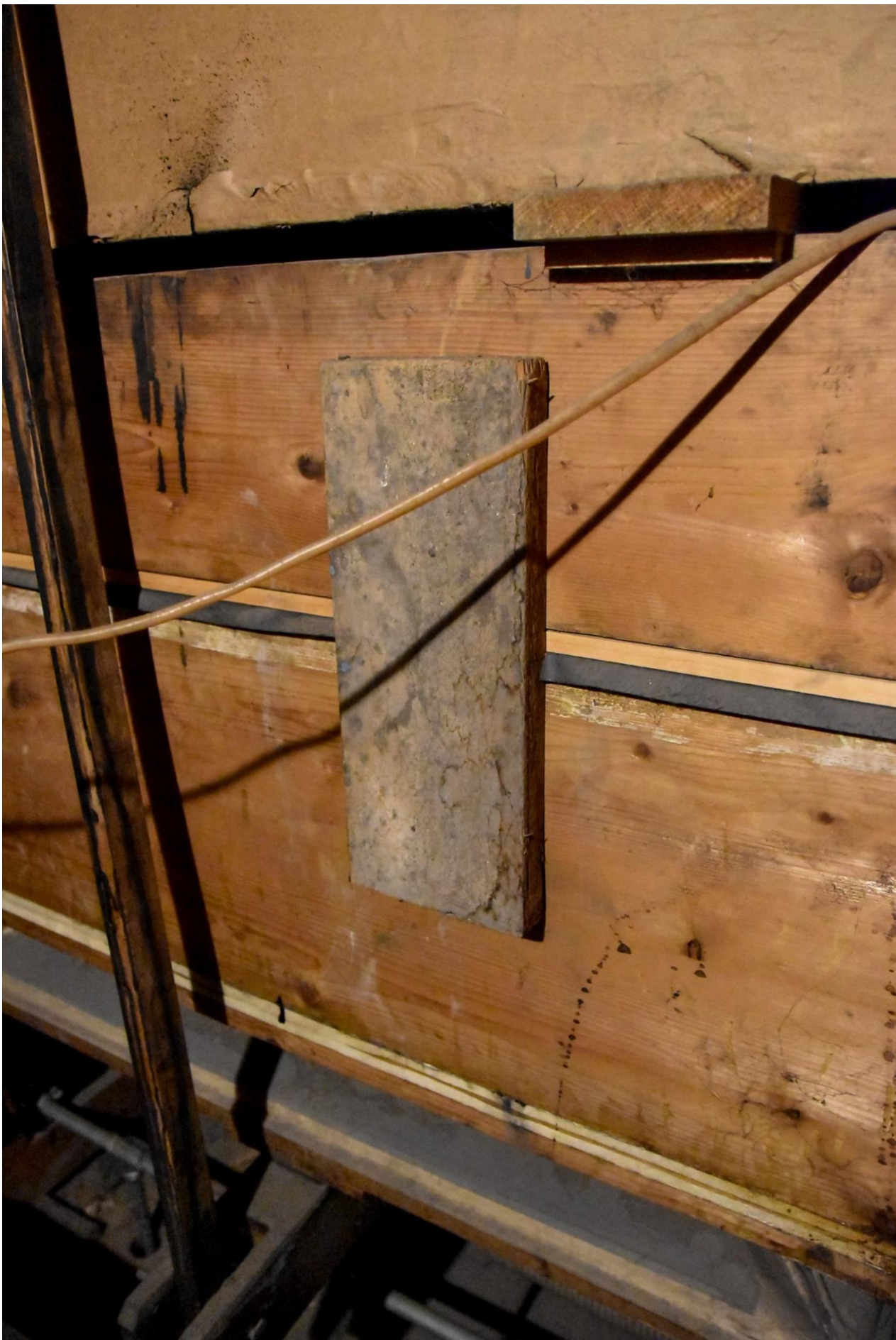
Fotografia 57 – przewód przekaźnikowy aparatu tremolo bez mocowania na tle miecha
