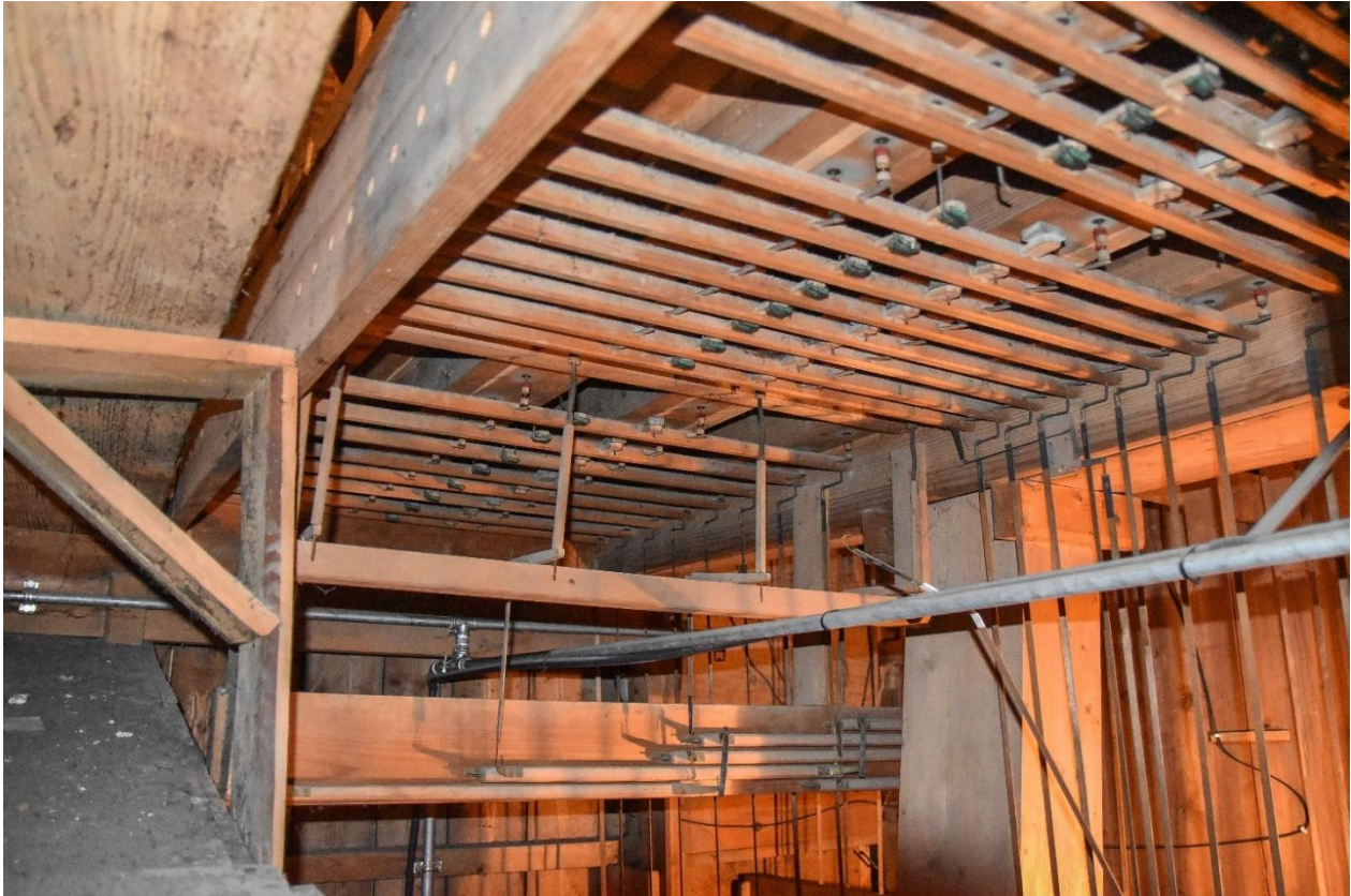
Fotografia 129 – dolna część wiatrownicy stożkowej sekcji pedałowej, widoczny kanał powietrzny, deska z wałkami skrętnymi traktury rejestrowej, włączniki dopływu powietrza do poszczególnych przegród rejestrowych, abstrakty i listwy tonowe oraz popychacze; warstwa kurzu koło otworów tonowych, w których osadzone są wentyle stożkowe
