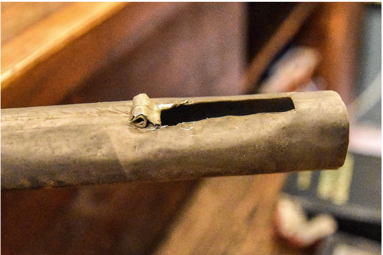
Fotografia 107 – okno ekspresyjne i nierówne zawinięcie dostroika w formie ślimacznicy
