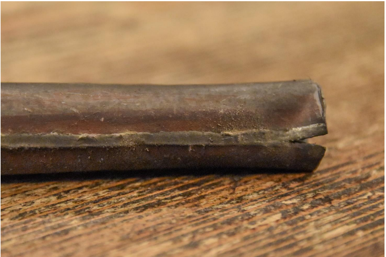
Fotografia 109 – zerwana górna korpusu, widoczne ślady po bolusie
