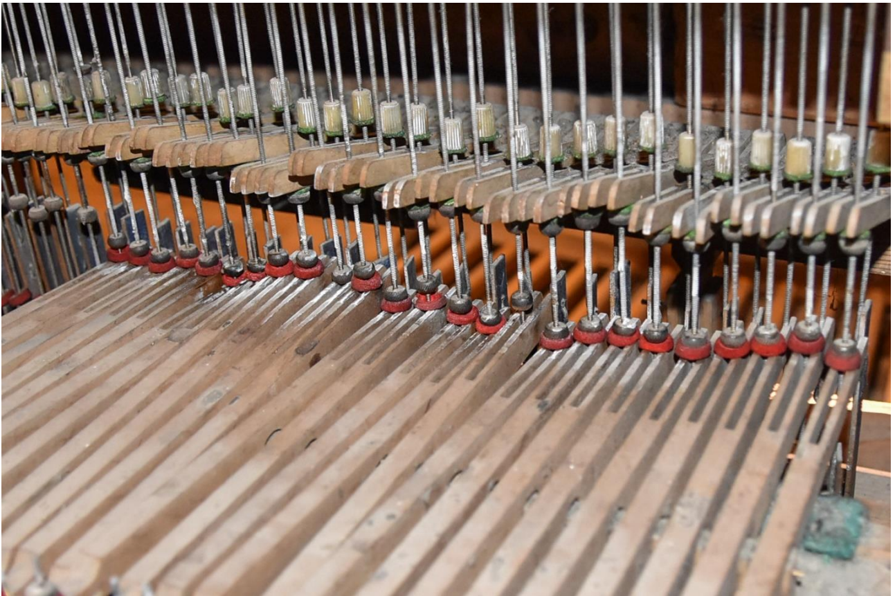
Fotografia 35 – połączenie I/P w tylnej części stołu gry, prawdopodobnie oryginalne nakrętki na dole, nowsze na górze, wyeksploatowany pasek filcu na listwie
