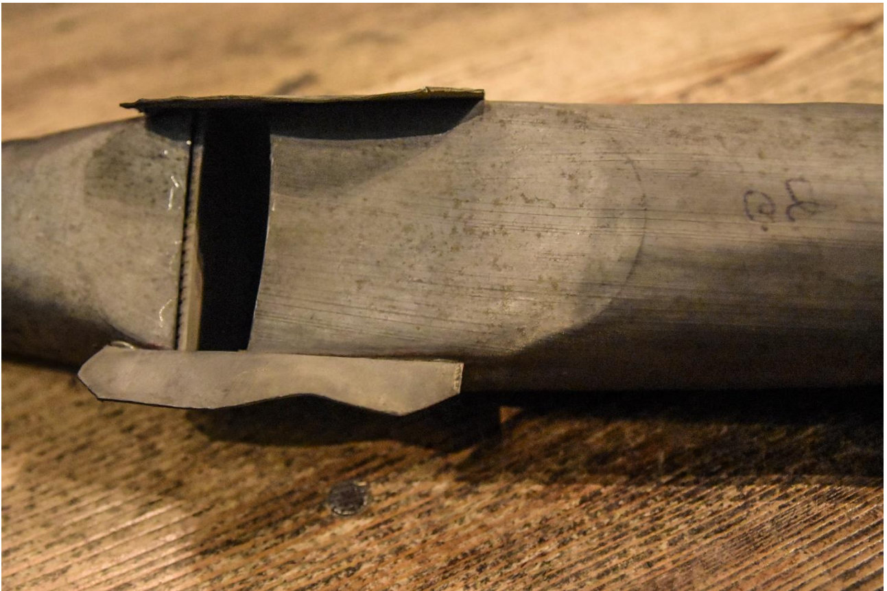
Fotografia 116 – charakterystyczna struktura metalu, wykrzywione baczki, półokrągłe wycięcie labium
