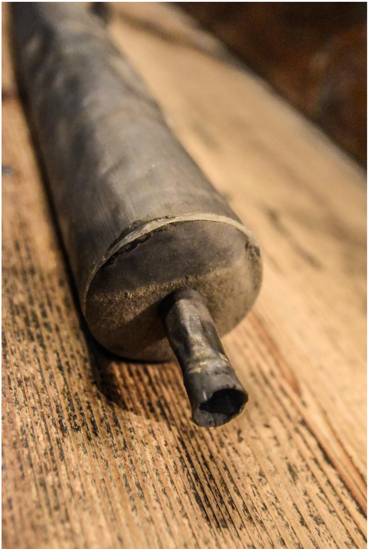
Fotografia 118 – zalutowany na stałe dekiel metalowej piszczałki półkrytej wraz z rurką, być może skróconą w trakcie przebudowy, podobnie, jak miało to miejsce w przypadku przebudowy organów na Wawelu przez syna Aleksandra Żebrowskiego, Aleksandra
