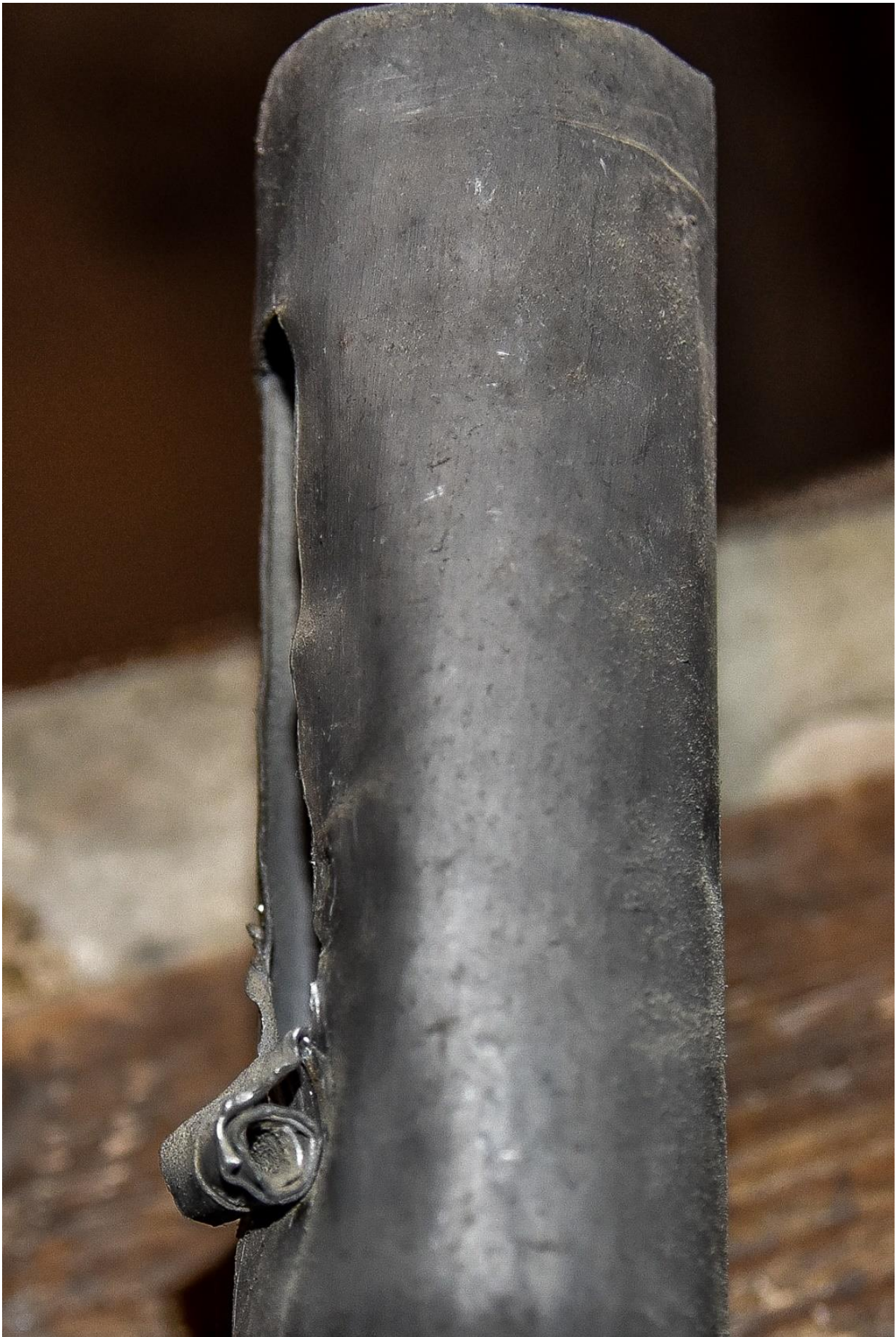
Fotografia 104 – forsownie wciśnięty punkt nawinięcia dostroika
