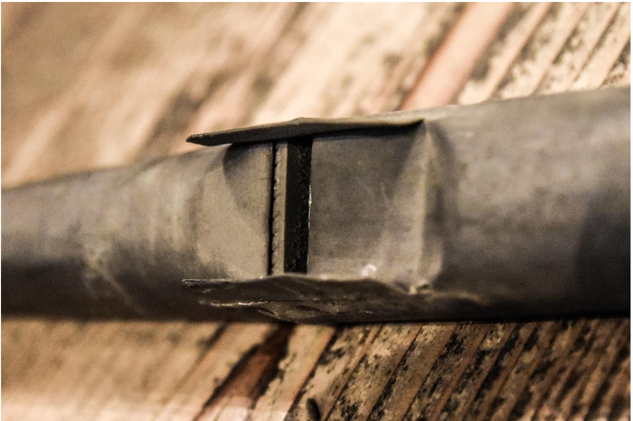
Fotografia 106 – przykład starszych puszczalek z ustawioną pod ostrym kątem specyficzną naciętą powierzchnią rdzenia
