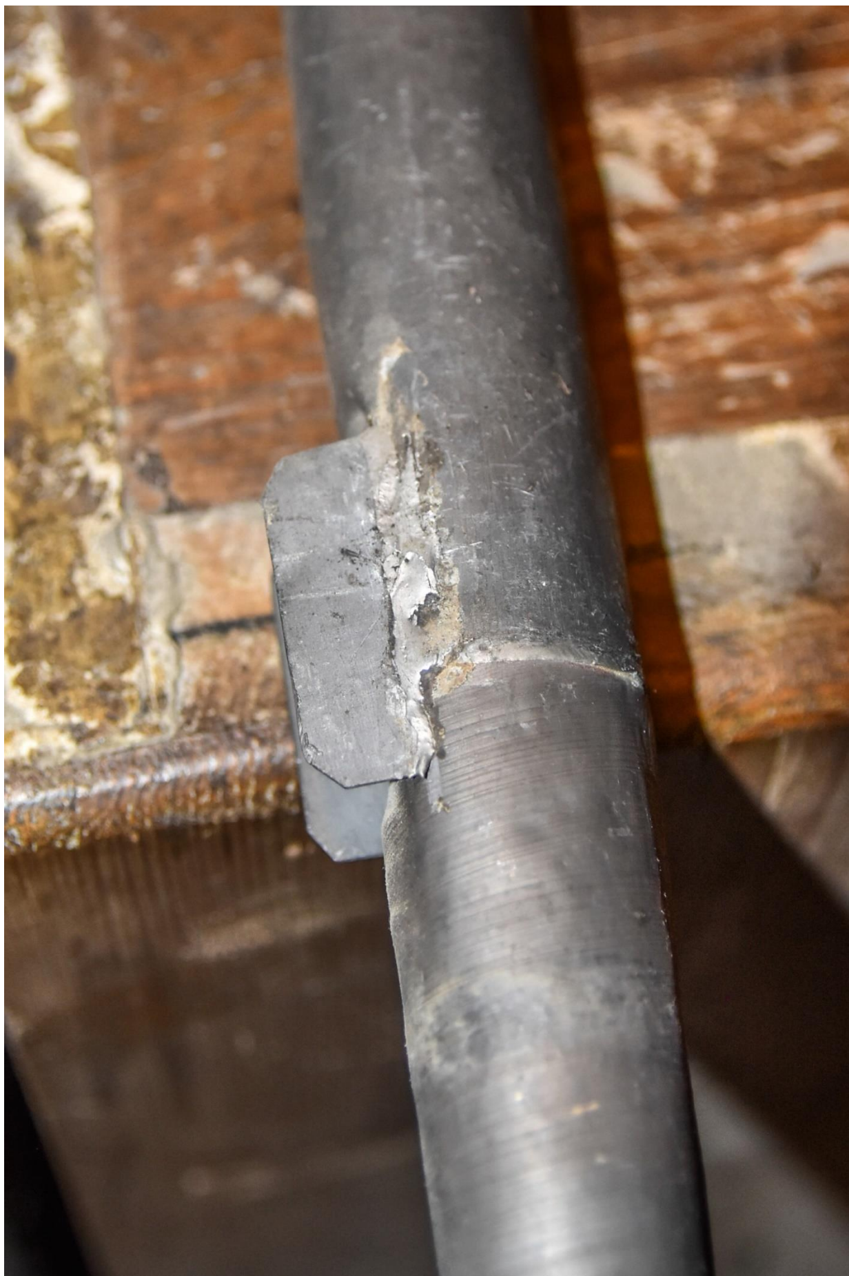
Fotografia 103 – dolutowane baczki do cylindrycznej piszczałki metalowej
