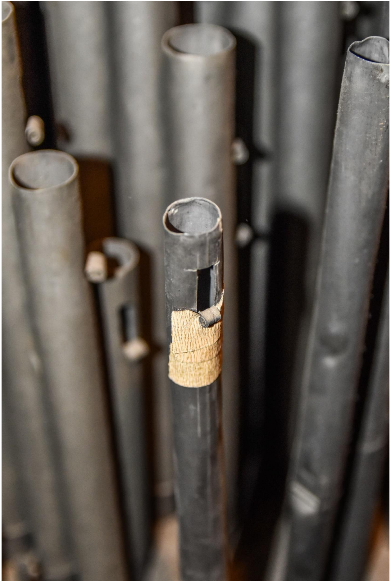
Fotografia 99 – górna część korpusu metalowej piszczałki wyposażona w dostroik i okno ekspresyjne
