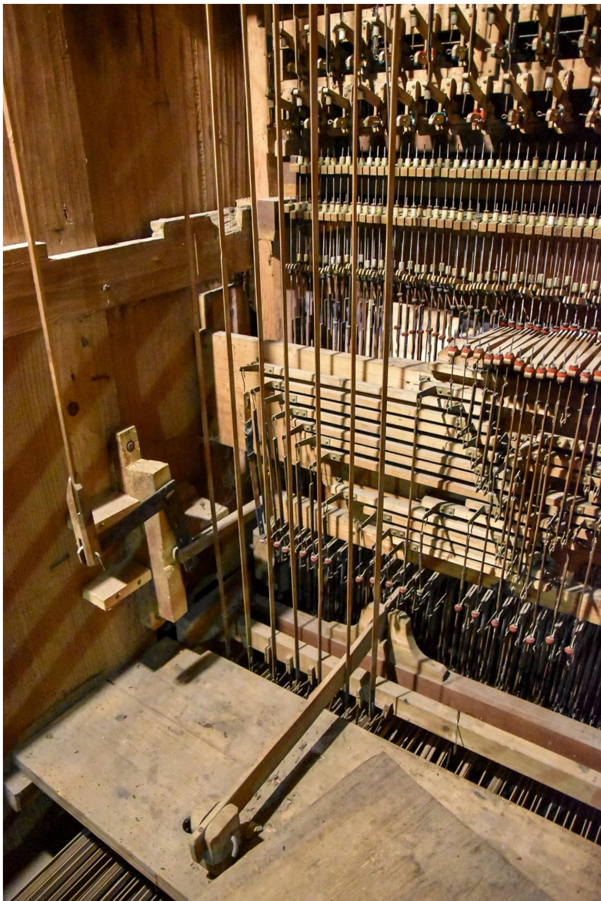
Fotografia 38 – traktura podłączona do dźwigni nożnych, po lewej stronie kątownik przekazujący impuls trójstopniowego otwarcia żaluzji sekcji ekspresyjnej
