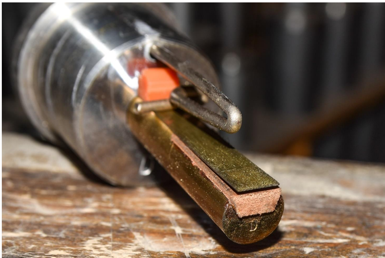
Fotografia 92 – widok głowicy piszczałki językowej z zaklinowaną oskórowaną rynienką i językiem
