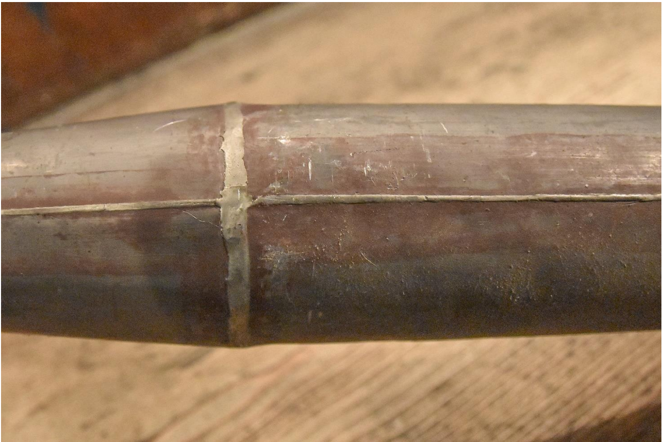
Fotografia 114 – przykład sposobu lutowania piszczałki metalowej
