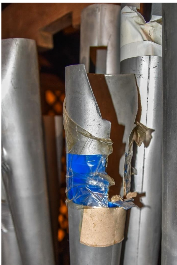
Fotografia 15 – cztery warstwy wykonanych chałupniczo prób strojenia piszczałek metalowych
