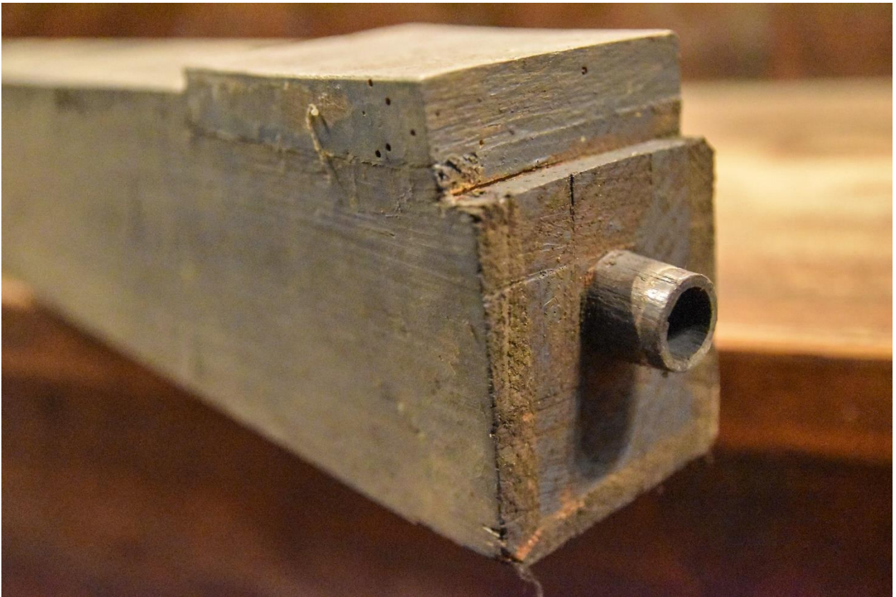
Fotografia 122 – otwory na lewej i dolnej krawędzi forszłagu puszczalki drewnianej będące wynikiem żeru owadów szkodników drewna
