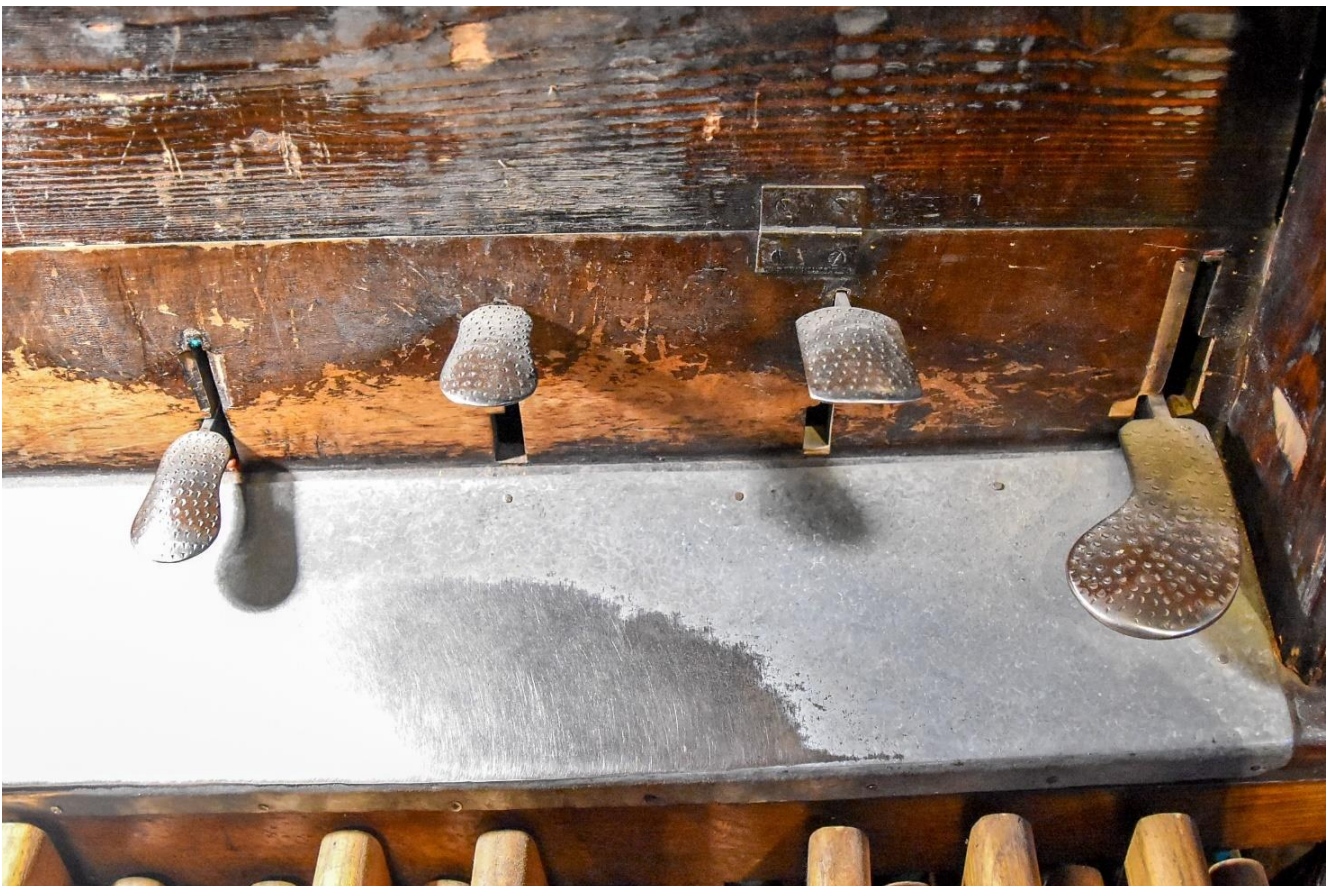
Fotografia 20 – włączniki nożne, po prawej stronie trzypozycyjne sterowanie otwarciem szafy ekspresyjnej
