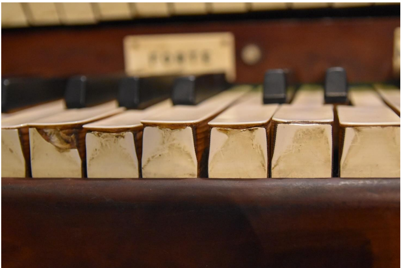
Fotografia 23 – zużycie nakładek klawiszy diatonicznych pierwszego manualu
