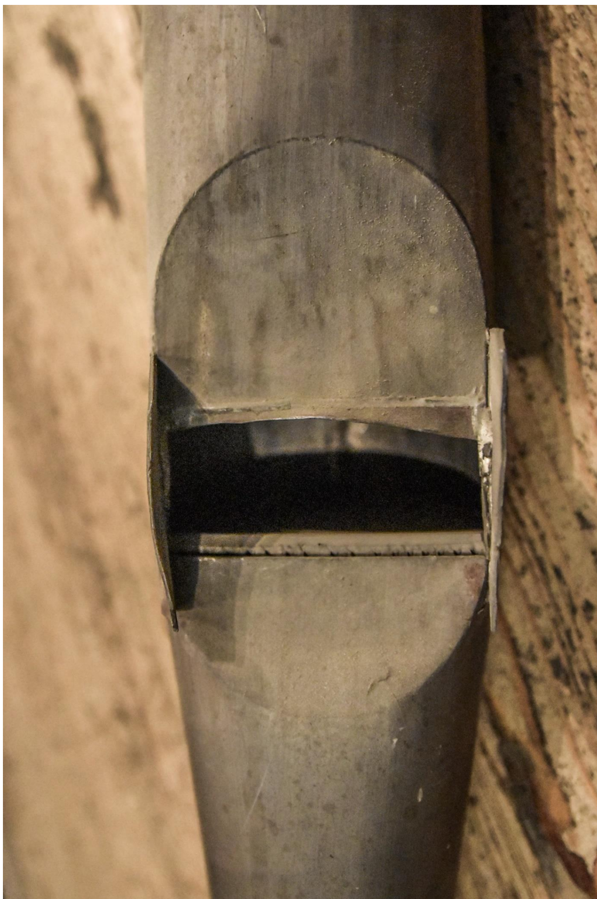
Fotografia 113 – dolutowane baczki, krzywe wycięcie górnego labium, widoczny ślad lutu górnej krawędzi
