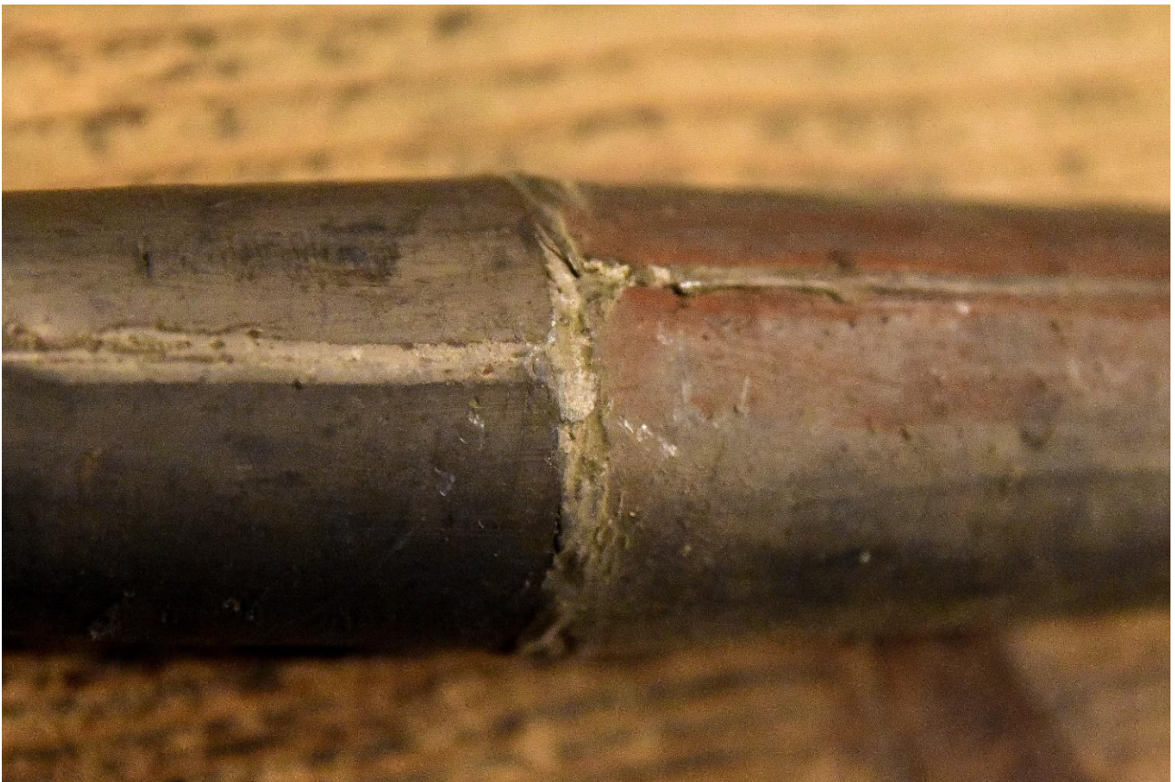
Fotografia 110 – tylna ścianka łączenia nogi i korpusu puszczalki metalowe, widoczne ślady po bolusie w części korpusowej
