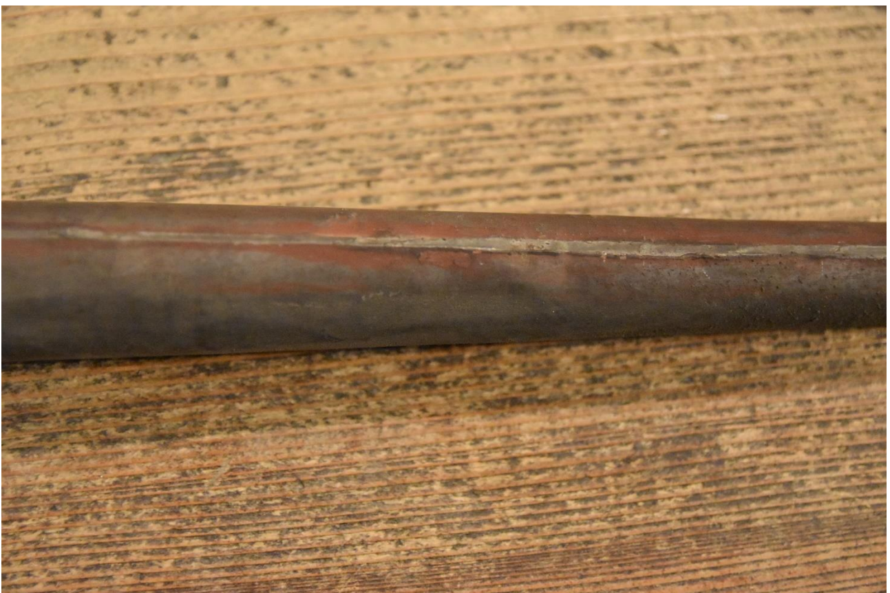
Fotografia 112 – fragment oryginalnego lutowania piszczałek, widoczna farba bolusowa
