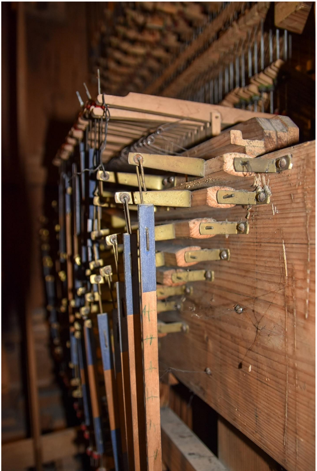
Fotografia 65 – blat trakturowy, widoczne prowizoryczne połączenie pierwszego wahacza i oznaczenia na abstrakcie wykonane zielonym długopisem
