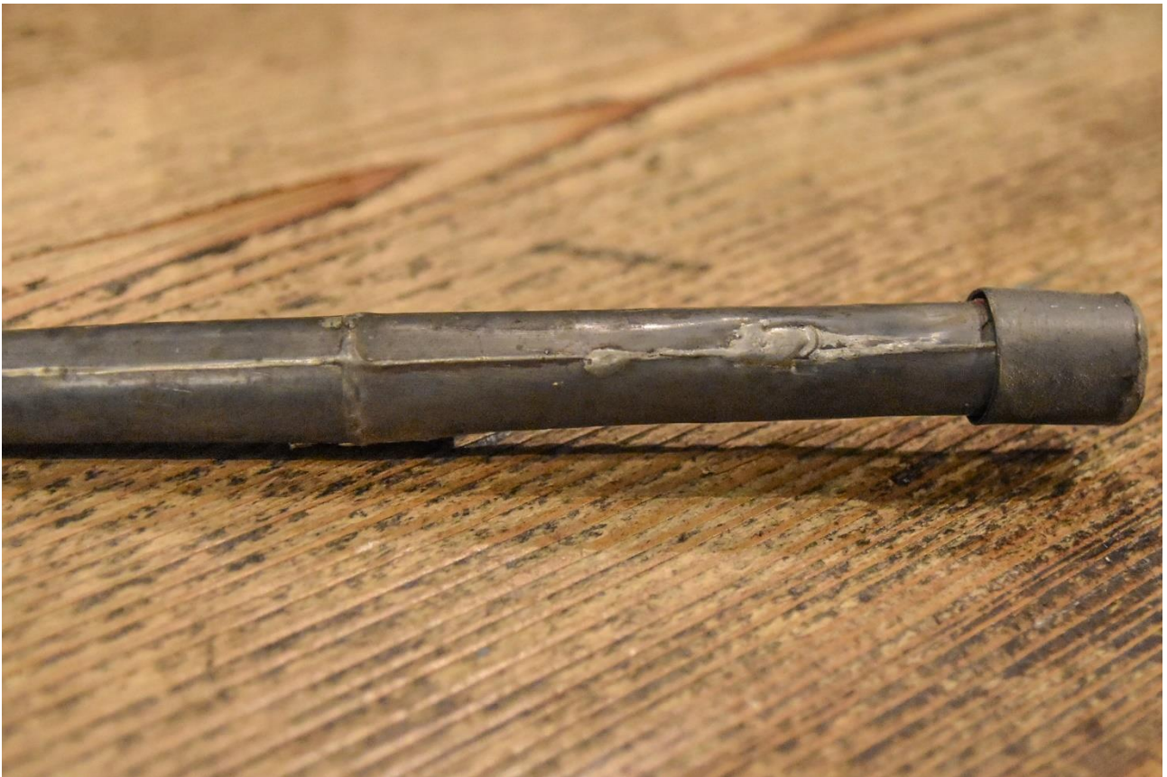
Fotografia 124 – metalowa piszczałka kryta ze śladami napraw środkowej części korpusu
